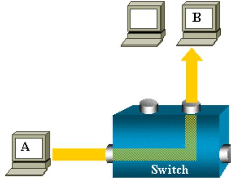
Switch mit SPAN-Port
